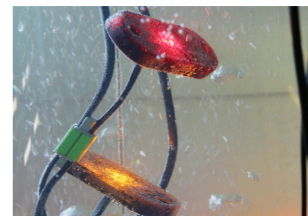
Prüfung auf Dichtheit in der Salzwassersäule
