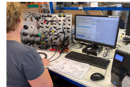
100% computerunterstützte Prüfung aller Teile / Komponenten
