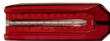
CLAAS Claas Lamp in ECE Version Typ: LED mit Blinkerausfallkontrolle
