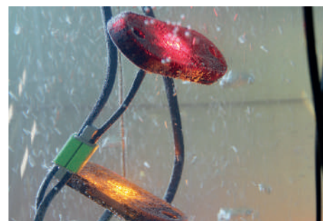
Prüfung auf Dichtigkeit in der Salzwassersäule
